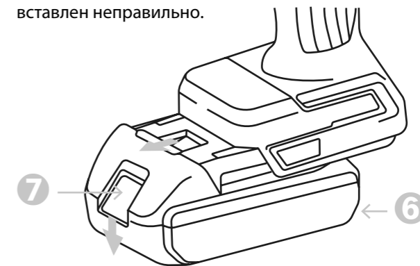
Рисунок 2.1.1. снятие аккумуляторного блока
